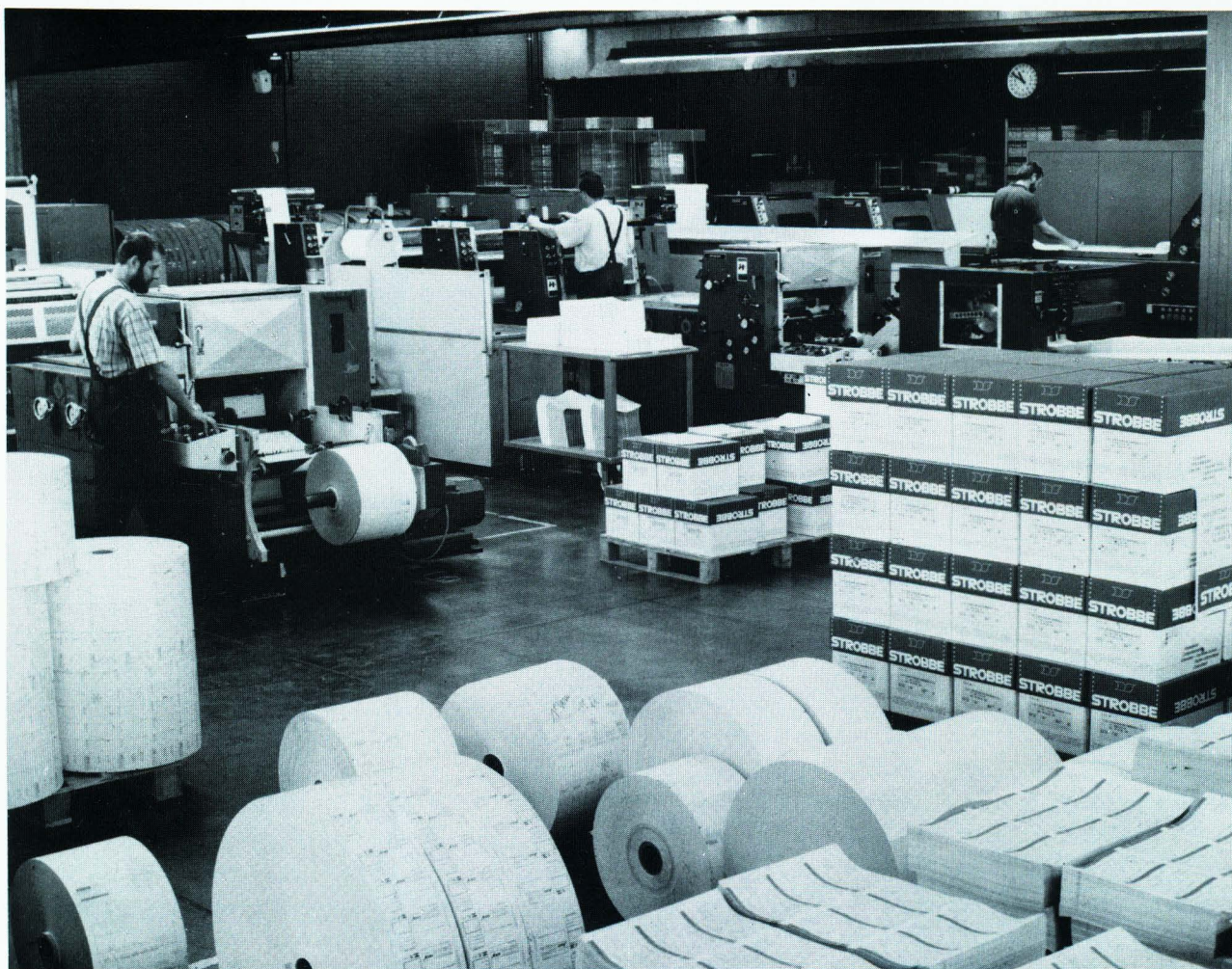
Meerkleuren-rotatiepersen voor formulieren- en kalenderdruk (foto-opname 1989).
